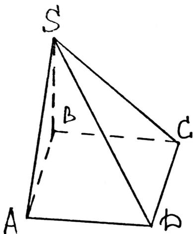
1) В силу того, что  $SB \perp BC$  и  $SB \perp AB$ , где  $AB \times BC$ , получается по признаку, что  $SB \perp ABC$  (все о  $\perp$ -х смотри в предыдущих пунктах)
